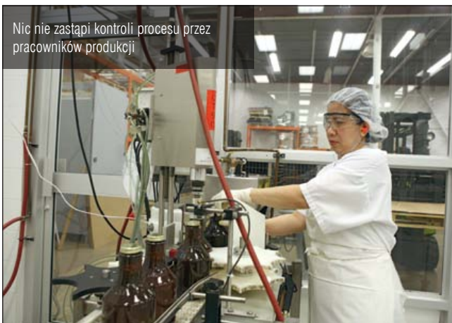
Jeden z ostatnich etapów produkcji – kapslowanie butelek
